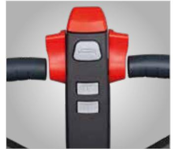
› Bequeme Steuerung von Geschwindigkeit, Fahrtrichtung und Bremsung über leicht ansprechende Wippentaster
