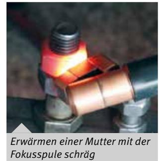
Erwärmen einer Mutter mit der Fokusspule schräg
