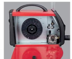
Im Innenraum umpolbar für Fülldrähte für 5kg Spule-Ø200
