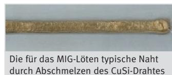
Die für das MIG-Löten typische Naht durch Abschmelzen des CuSi-Drahtes
