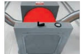
Integrierte Hebevorrichtung für den Filterwechsel
