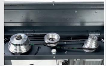
Abb. Riemenantrieb DQ 22.
