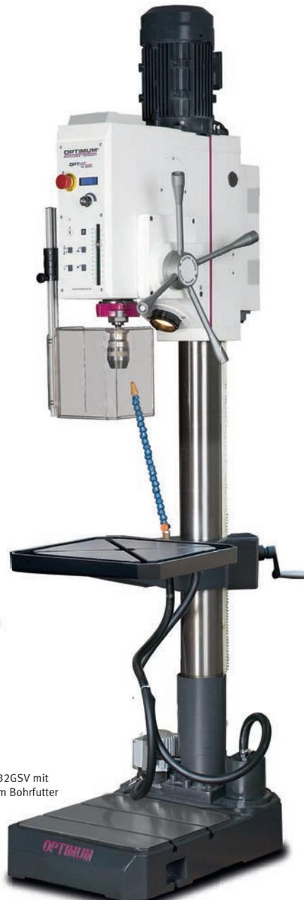
Abb.: DH 32GSV mit optionalem Bohrfutter
