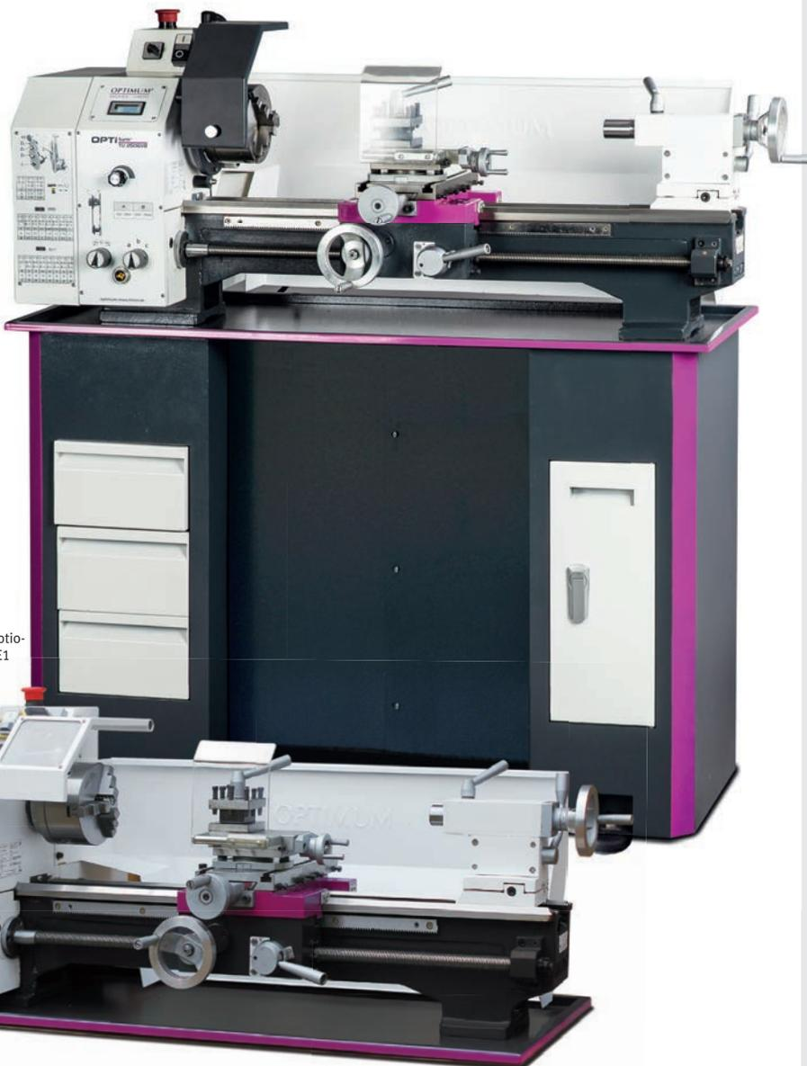
Abb.: TU 2506VB mit optionalem Unterbau und SE1
