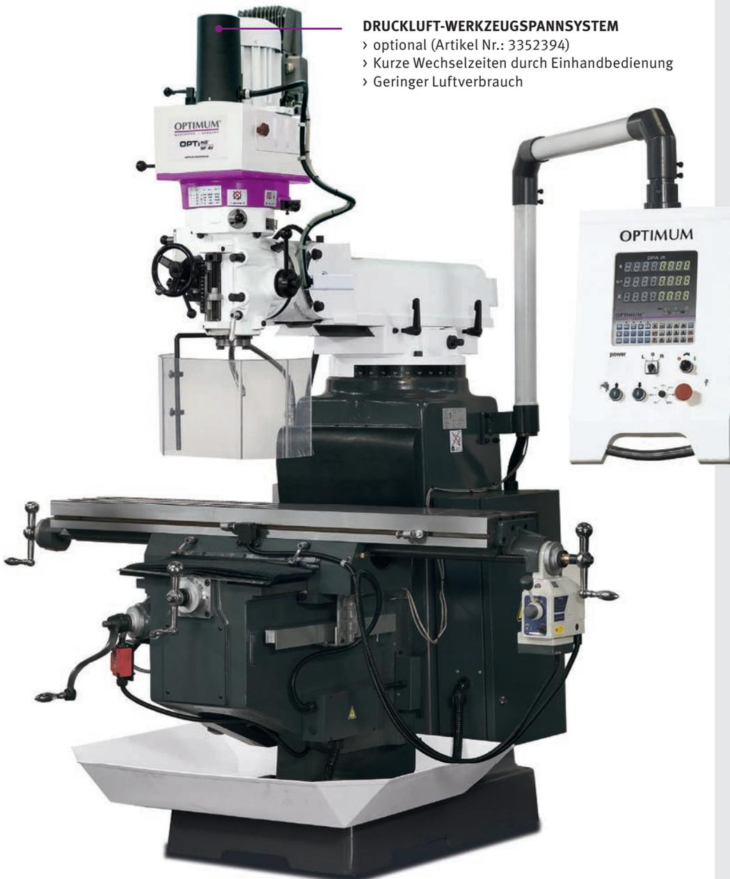
Abb.: MF 4V mit optionalem Druckluftwechsler
