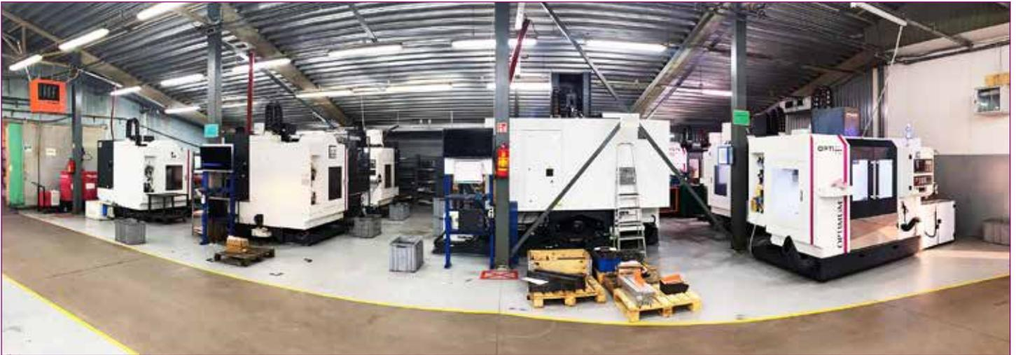
Sieben CNC-Fräsmaschinen F 150 und zwei CNC Fräsmaschinen F310 HSC in einer der Fertigungshallen bei Baltec
