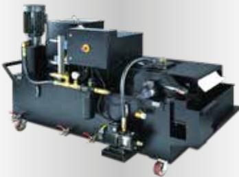
Abbildung Aggregat extern mit Papierfilter
