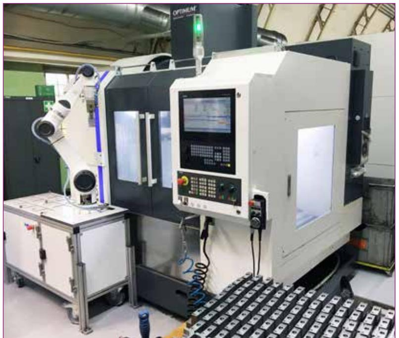
Mit Roboter gekoppelte OPTIMUM CNC-Maschinen
