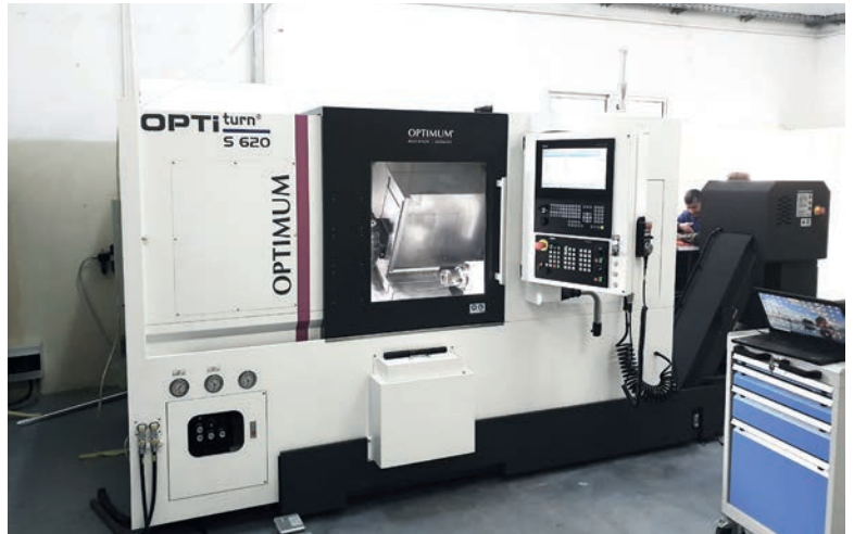
OPTIMUM PREMIUM CNC-Schrägbett-Drehmaschine S 620 mit Gegenspindel
