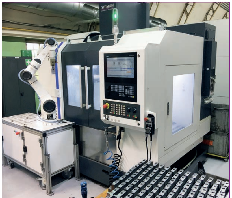
Mit Roboter gekoppelte OPTIMUM CNC-Maschinen
