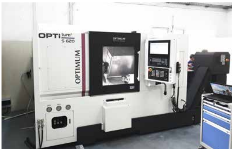
OPTIMUM PREMIUM CNC-Schrägbett-Drehmaschine S 620 mit Gegenspindel
