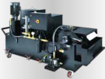
Abbildung Aggregat extern mit Papierfilter
