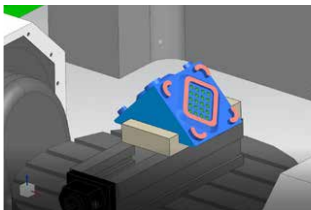
Abb.: OPTimill FU 5: Die Aufspannung und Fertigung des Werkstücks kann in der Simulation verifiziert werden. Das Bauteil kann aus allen Blickrichtungen betrachtet werden. Auch die kritischen Kollisionsbereiche der Maschine können angesehen werden.
