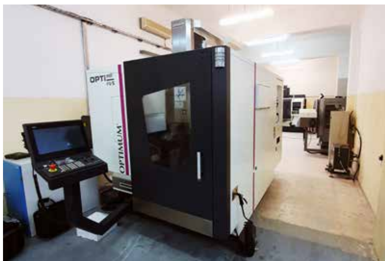
5-Achsen-Simultan-Bearbeitungszentrum OPTIMUM PREMIUM FU 5
