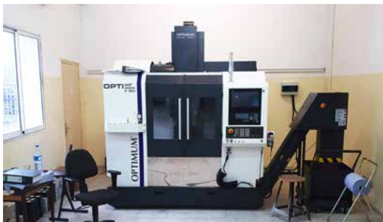
Dreiaxige Fräsmaschine OPTIMUM PREMIUM F150 HSC
