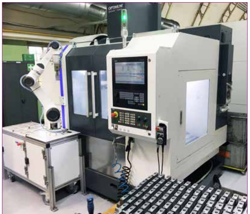
Mit Roboter gekoppelte OPTIMUM CNC-Maschinen
