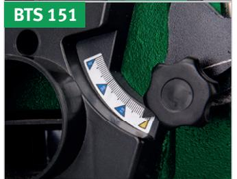
Der robuste Arbeitstisch ist von 0° bis 45° schwenkbar. Die eingestellte Neigung kann anhand einer Skala abgelesen werden.
