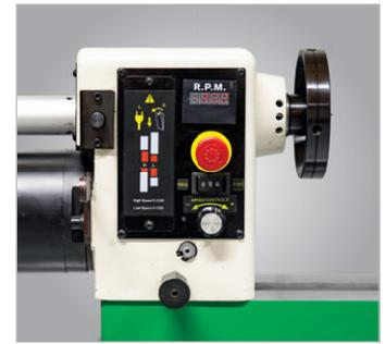
Digitalanzeige für Drehzahl integriert
