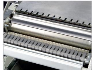
Automatischer, gleichmäßiger Vorschub mit Rückschlagsicherung. Die verzahnte Einzugswalze gewährt einen konstanten Holzeinzug.
