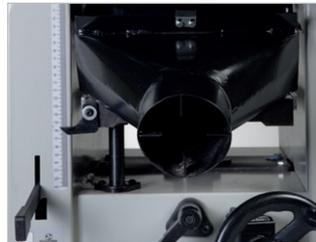
Dicktischverstellung über Handrad, Skala und numerischer Anzeige
