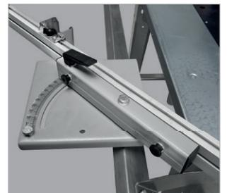
Kugelgelagerter Schiebeshlitten mit Gehrungsanschlag, stufenlos einstellbar von 0 bis 45° mit Schnellklemmhebel
