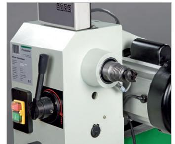
Über einen Hebel an der Bedienerseite ist die gewünschte Drehzahl schnell und bequem einstellbar
