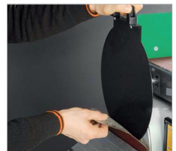
**Optional: Trennblech zum Schleifscheibenwechsel**
