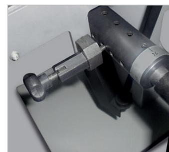
Reihenbohrungen durch Dübelbohreinrichtung mit Rasterteilung 16/22/25/32 mm möglich
