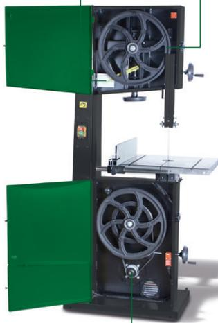
Zwei Geschwindigkeiten über Keilriemenverstellung wählbar
