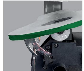
Tischwinkel über Skala genau einstellbar
