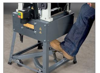
Das serienmäßige Fahrwerk mit zwei Lenkrollen ermöglicht einen leichten Transport. Zum Bewegen der Maschine wird einfach auf den Fahrwerksbügel getreten, wodurch die Rollen nach unten gebracht werden. Über einen Federbügel kehrt das Fahrwerk in die Ausgangsstellung zurück.
