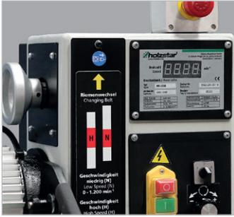
Variable Drehzahlregulierung in zwei Geschwindigkeitsstufen
