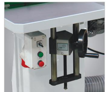
Höhenverstellbarer Schleiftisch zur Ausnutzung der gesamten Schleifbandbreite
