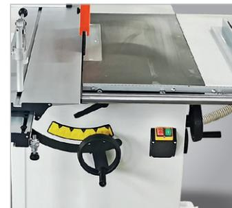
▶ Sägeblatthöhe und -schwenkung bequem über Handräder einstellbar
