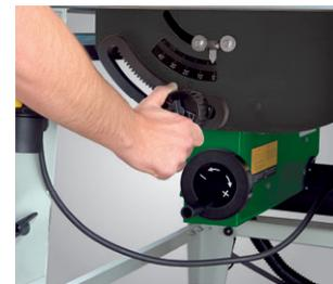
Mit genauer und leichtgängiger Höhen- und Schrägverstellung des Sägeaggregats durch einfach zu bedienende Handräder.
