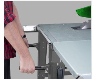
Komfortabel verfahrbar durch Fahrwerk und klappbare Transportgriffe
