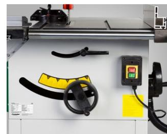
Mit genauer und leichtgängiger Höhen- und Schrägverstellung des Sägeaggregats durch einfach zu bedienendes Handrad
