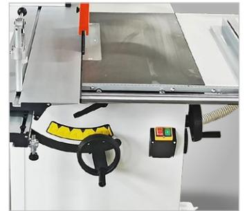
▶ Sägeblatthöhe und -schwenkung bequem über Handräder einstellbar
