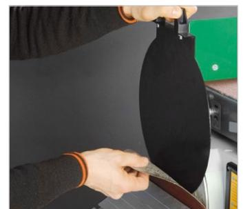
**Trennblech zum Schleifscheibenwechsel**
