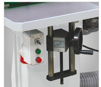
Höhenverstellbarer Schleiftisch zur Ausnutzung der gesamten Schleifbandbreite
