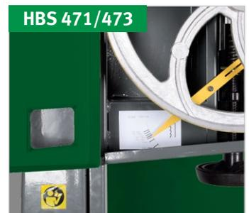
Die Sägebandschnellspannung ist von außen durch ein in der Tür integriertes Sichtfenster ablesbar
