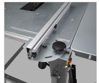
Leichte und präzise Einstellung des Parallelanschlags mit Exzenter-Schnellspannung per Skala
