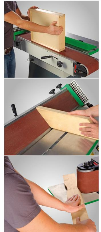
Durch das stufenlos schrägverstellbare Schleifaggregat ist die Kantenschleifmaschine für verschiedenste Schleifvorgänge wie z. B. vertikales und horizontales Schleifen verwendbar
