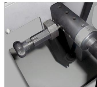
Reihenbohrungen durch Dübelbohrereinrichtung mit Rasterteilung 16/22/25/32 mm möglich
