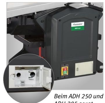
Beim ADH 250 und ADH 305 sorgt ein integriertes Aufbewahrungsfach für Stauraum. So kann z.B. kleines Bedienwerkzeug platzsparend aufbewahrt und mitgeführt werden.
