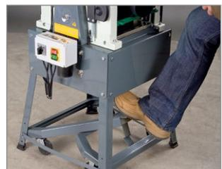
Das serienmäßige Fahrwerk mit zwei Lenkrollen ermöglicht einen leichten Transport. Zum Bewegen der Maschine wird einfach auf den Fahrwerksbügel getreten, wodurch die Rollen nach unten gebracht werden. Über einen Federbügel kehrt das Fahrwerk in die Ausgangsstellung zurück.
