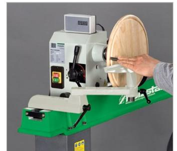
Für Drehselarbeiten an Werkstücken im Querholzbetrieb, die größer als das Stichmaß der Bank sind, kann der Spindelstock geschwenkt werden. Die Bettverlängerung in Verbindung mit der umsteckbaren Handstahlaufgabe ermöglichen maximale Flexibilität.
