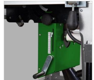
Einfache manuelle Höhenverstellung des Sägeaggregats über Handkurbel, Neigungsverstellung von 0 – 45°
