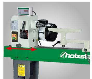
Der Spindelkasten der DB 1100 kann zusätzlich seitlich verschoben und an jeder Stelle des Drehselbettes arretiert werden.
