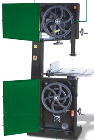
Zwei Geschwindigkeiten über Keilriemenverstellung wählbar
