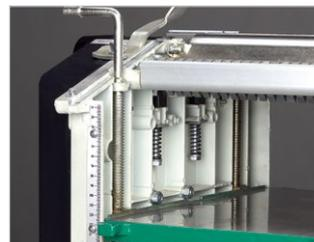
Die durch Federn gelagerten Einzugswalzen verhindern Eindrücke auf dem Holz. Der Dickentisch wird auf vier Säulen geführt.
