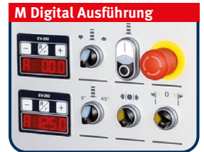
▶ mit motorisch höhenverstellbarer und schwenkbarer Frässpindel
