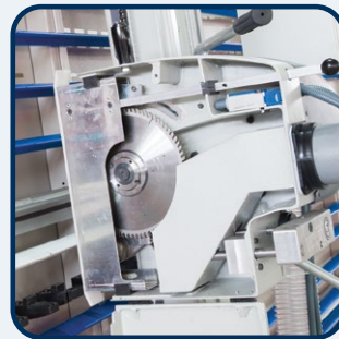
▶ Große Öffnung für Sägeblattwechsel
