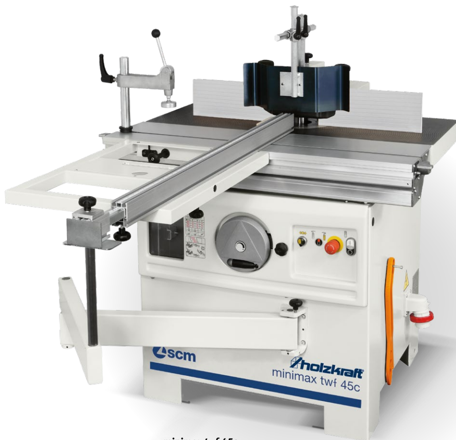
minimax twf 45c mit Alu-Schiebeschlitten, sowie Supportausleger auf Schwenkarm
