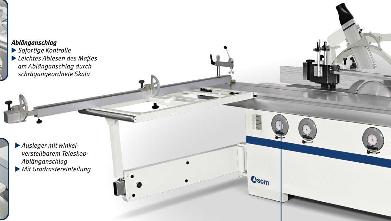
Mit festen Handrädern mit integrierter Gradanzeige
