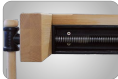
Massive Linearführung an der Hinterzange
