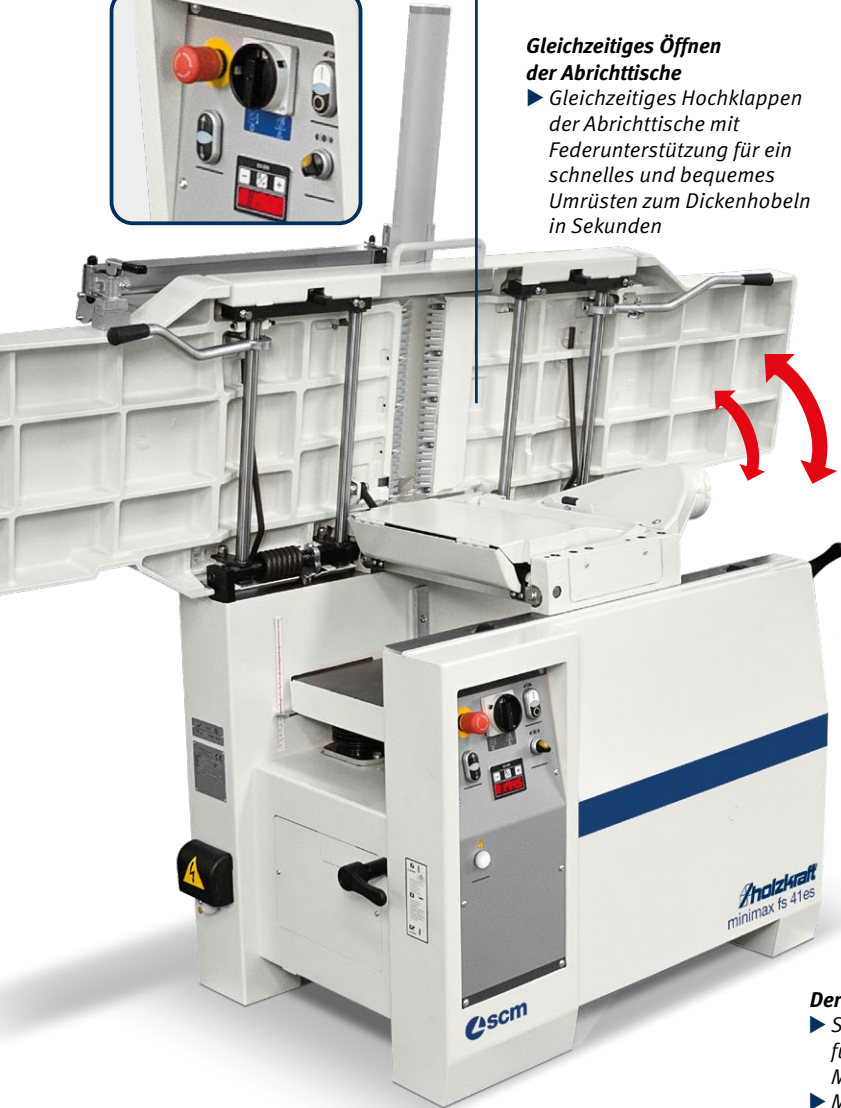
Abb. zeigt minimax fs 41es TERSA Digital ▶ Mit motorischer Höhenverstellung und Digitalanzeige
