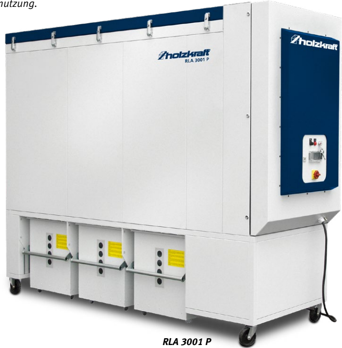
Abreinigung erfolgt durch Druckluftimpulsstöße, die den Filter von innen nach außen abreinigen. Die dadurch hervorgerufene mechanische Verformung der Filter optimiert den Regenerationsgrad bei starker Verschmutzung.
