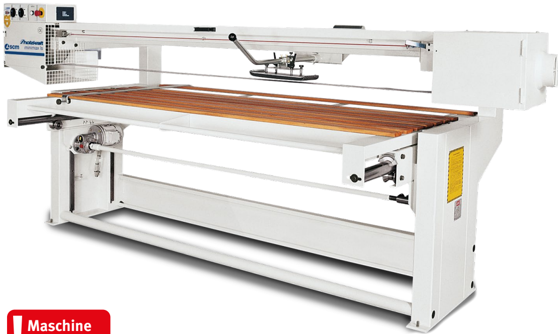
Die Bandschnellspannung ermöglicht schnelles und problemloses Wechseln der Schleifbänder.
