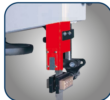
Untere und obere Sägeblattführung mit Elementen aus Bronze
