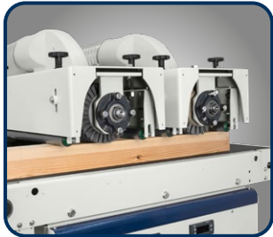
▶ Arbeitsaggregate können einzeln zugeschaltet werden
