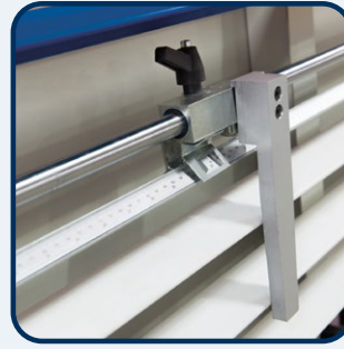
▶ Lineal zur Längeneinstellung beim Vertikalschnitt
