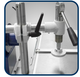
▶ Manueller Exzenterstpanner mit großem Auflageteller zum Fixieren des Werkstücks
