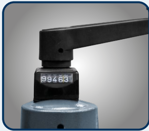
► Vorschubapparate serienmäßig mit Zählwerk für Höhenverstellung
