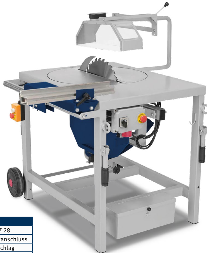
Sägeblattdrehung um bis zu 90°
