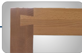
Schwalbenschwanz-Verzinkung in Hinterzange und Beiladerücken
