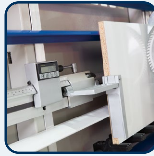
▶ Digitale Maßanzeige zur Längeneinstellung beim Vertikalschnitt
