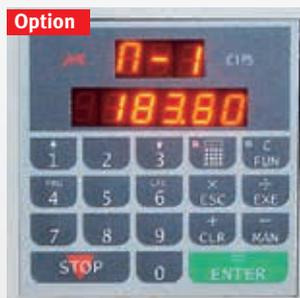
Option Elektronische Dickentischpositionierung über Tastatur mit Inkremental- und Taschenrechnerfunktion PS 630
