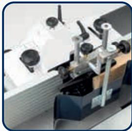
▶ Der Frässchutz ist für maximale Sicherheit serienmäßig mit einer höhenverstellbaren Führungsschiene und Schutzblech ausgestattet
