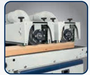
▶ Arbeitsaggregate können einzeln zugeschaltet werden
