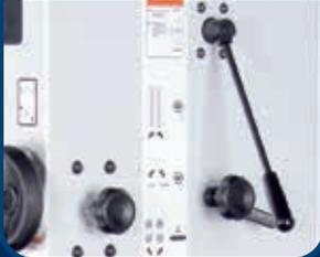
· Sägebandschnellspannung über Exzenterhebel auf der Maschinenrückseite
