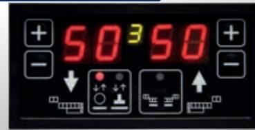
Synchronisiert den automatischen Einsatz des Schleifschuhes im Ein- oder Auslauf des Werkstücks mit jeder Vorschubgeschwindigkeit. Lieferbar auf Wunsch für alle Maschinen
