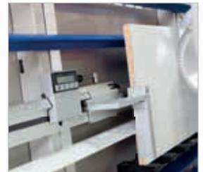
▶ Digitale Maßanzeige zur Längeneinstellung beim Vertikalschnitt
