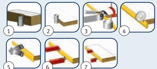
**HOLZKRAFT minimax me 35tn er – Kantenanleimmaschine für Kunststoffkanten von 0,4 - 3 mm, Massivholzkanten bis 5 mm und Werkstücke von 8 - 50 mm**
