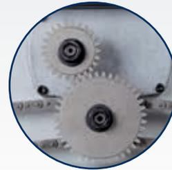
▶ Vier weitere Geschwindigkeiten durch Wechselgetriebe
