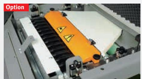
Abb. zeigt Option "Pneumatische Druckeinstellung der Vorschubwalzen" für PS 630
