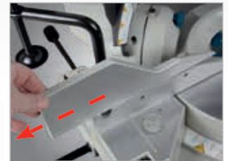
Ausziehbare Anlageschienen und ausziehbarer Tisch
