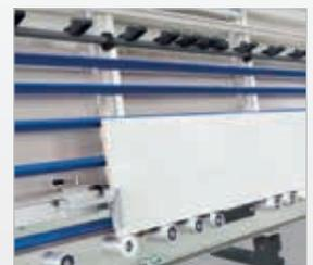
▶ Einfacher und schneller Zuschnitt auch kleinerer Teile. Untere Plattenauflage mit Maßanzeige.
