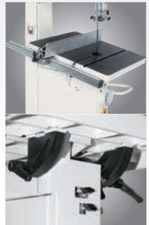
▶ Sägertisch mit Schwenkeinrichtung aus Grauguss, schwenkbar bis 20°
