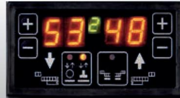
Aktivierung der Sektoren über die elektronische Steuerung, welche deren Einsetzen mit der Vorschubgeschwindigkeit synchronisiert und die Steuerung des elektronischen Gliederschleifschuhs erlaubt. (serienmäßig mit dem elektronischen Gliederschleifschuh geliefert).
