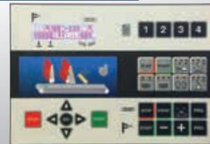
Diese Steuerung kontrolliert die ganze Maschine und der sequentielle Einschaltung der Motoren. Möglichkeit von Speicherung von 4 Arbeitsprogrammen. FOX 500 ST steuert den elektronischen Gliederschleifschuh, wenn die Maschine mit diesem ausgerüstet ist. Lieferbar für LIBRA 35, 45 & 65.
