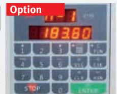
**Option PFS 520:** Elektronische Dickentischpositionierung über Tastatur mit Inkremental- und Taschenrechnerfunktion
