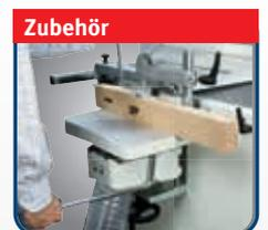
Option Langlochbohrereinrichtung mit Wescott-Bohrfutter 0-16 mm
