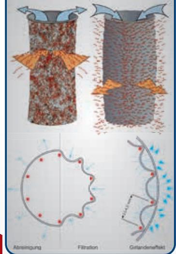
Abreinigung erfolgt durch Druckluftimpulsstöße, die den Filter von innen nach außen abreinen. Die dadurch hervorgerufene mechanische Verformung der Filter optimiert den Regenerationsgrad bei starker Verschmutzung.
