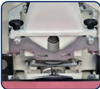
**Bündig- und Radiusfräsaggregat für optimale Bearbeitung der Kanten**
