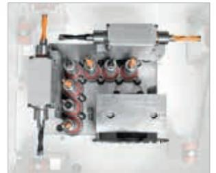
Bohraggregat mit vertikalen und horizontalen Bohrspindeln für hohe Flexibilität, auch ideal für „Losgröße 1“-Möbelfertigung
