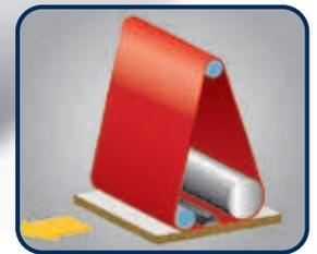
**Kombiaggregat zum Kalibrieren und Schleifen**
