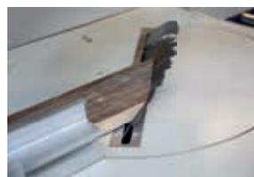
▶ Sägeblattschwenkung bis 45° und -drehung um bis zu 90°
