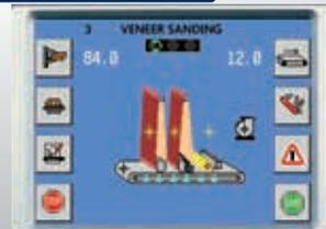
Steuerung mit Bildschirm LCD 5,7" mit "Touch Screen" und PLC. Diese Steuerung kontrolliert die ganze Maschine und die sequentielle Einschaltung der Motoren. Möglichkeit der Speicherung von 120 Arbeitsprogrammen. FOX 1000 S steuert den elektronischen Gliederschleifschuh, wenn die Maschine mit diesem ausgerüstet ist. FOX 1000 S ist lieferbar für LIBRA 45 und 65.
