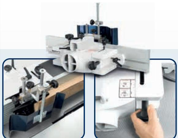
· Der Standard-Frässchutz ist für maximale Sicherheit serienmäßig mit einer höhenverstellbaren Führungsschiene und Schutzblech ausgestattet.
