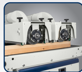
▶ Arbeitsaggregate können einzeln zugeschaltet werden
