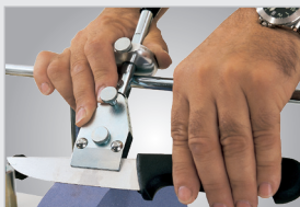
Vorrichtung für kleine Messer (Art.-Nr.: 5760056)
