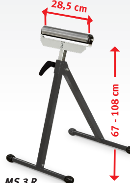
MS 3 R Mit Rollenaufgabe und Handgriff zur Schnellverstellung. Tragfähigkeiten: ▶ Niedrigste Position: 90 kg ▶ Mittlere Position: 60 kg ▶ Höchste Position: 45 kg
