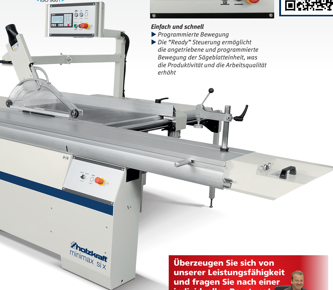
Sägeblattpendelschutz mit Absaughaube (manuell einstellbar)
