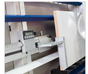
▶ Digitale Maßanzeige zur Längeneinstellung beim Vertikalschnitt
