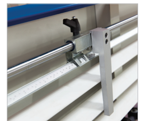
▶ Lineal zur Längeneinstellung beim Vertikalschnitt
