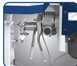
KSO 150 M Schleifaggregat über Hebel bis 45° schwenkbar
