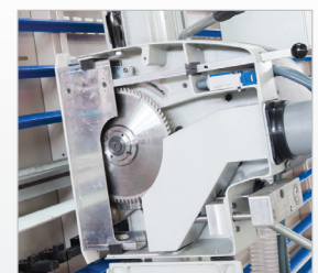
▶ Große Öffnung für Sägeblattwechsel
