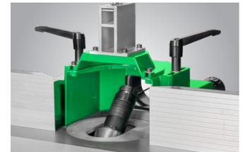
Nach hinten schwenkbare Frässpindel für optimalen Einsatz eines Vorschubapparates, ein Maximum an Sicherheit und ein sauberes Fräsbild
