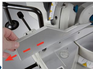
Ausziehbare Anlageschienen und ausziehbarer Tisch
