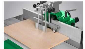
Fräsanschlag mit feineinstellbaren Aluminium-Anschlägen
