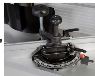
Stufenlos verstellbarer Winkelanschlag
