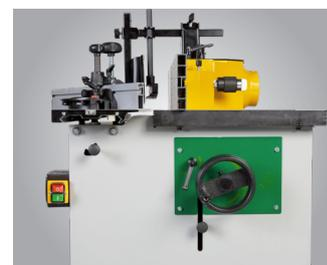
Handrad für Höhenverstellung. Sicherheitsvorrichtungen im Lieferumfang
