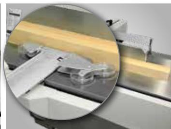
▶ Dadurch ist die Messerwelle immer bedeckt, was eine größere Sicherheit bietet
