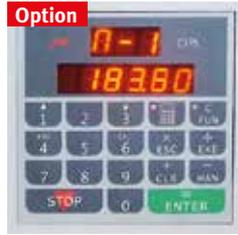
**Option:** Elektronische Dickentischpositionierung über Tastatur mit Inkremental- und Taschenrechnerfunktion
