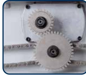
▶ Vier weitere Geschwindigkeiten durch Wechselgetriebe
