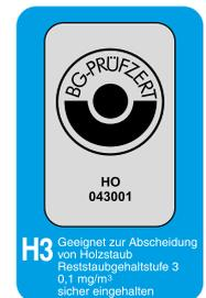
Alle Geräte dieser Serie staubgeprüft nach H3, Reststaubgehalt unter 0,1 mg/m<sup>3</sup>
