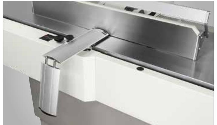
▶ Die TX-Matic Schutzvorrichtung ist abklappbar und wurde so konzipiert, dass der Bediener bei der Arbeit nicht behindert und gleichzeitig geschützt wird
