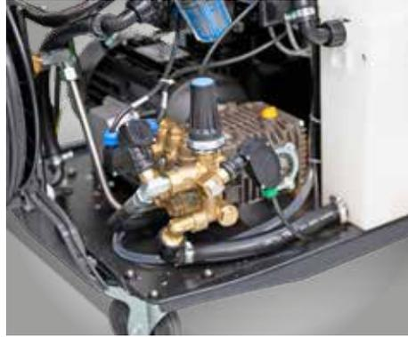
▶ Hochwertiger Messingzylinder mit stufenloser Druckregelung
