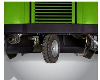
Der Antrieb über das hintere Antriebsrad ermöglicht wendiges und sicheres Fahren mit sehr engen Kurvenradien
