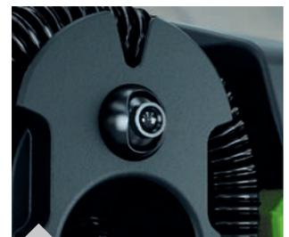
Hinterere Kamera zur Kontrolle der Reinigungsleistung
