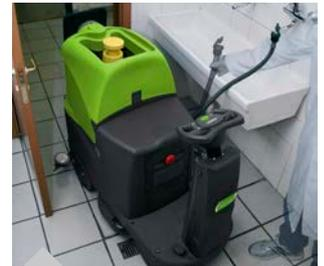
Frischwassertank mit Schlauch für Schnellbefüllung
