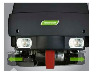
Reinigungsbürsten mit automatischem Einzug bei Stößen
