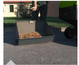
Manuelle Entleerung des Kehrgutbehälters
