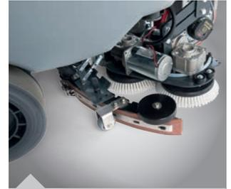
Vier kleine Scheibenbürsten, mit direkt dahinter liegender Absaugleiste, ermöglichen eine kurze Bauform und einen sehr kleinen Wendekreis. Die gebogene Absaugleiste direkt hinter der Scheibenbürste, folgt ständig der Fahrrichtung und garantiert eine perfekte Trocknung auch in Kurvenfahrt
