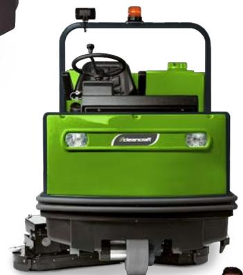
Reinigungsbürsten mit automatischem Einzug bei Stößen
