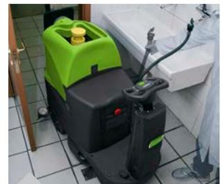
Frischwassertank mit Schlauch für Schnellbefüllung
