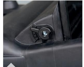
HKM 800: Einfache und werkzeuglose Höhenverstellung der Kehrwalze
