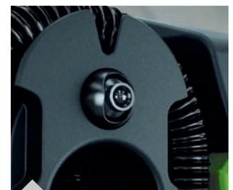
Hinterere Kamera zur Kontrolle der Reinigungsleistung
