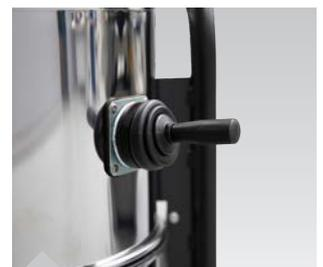
Manuelle Filterabreinigung garantiert eine gleichbleibend hohe Saugleistung
