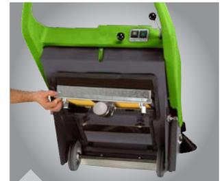
Der Plattenfilter lässt sich einfach und werkzeuglos auswechseln.
