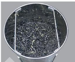
Metallspäne werden durch einen Sieb von der Kühlflüssigkeit getrennt
