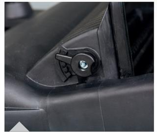
**HKM 800:** Einfache und werkzeuglose Höhenverstellung der Kehrwalze
