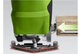
Reinigungsbürsten mit automatischem Einzug bei Stößen
