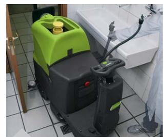
Frischwassertank mit Schlauch für Schnellbefüllung
