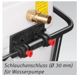
Schlauchanschluss (Ø 30 mm) für Wasserpumpe
