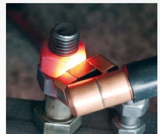
▶ Erwärmen einer Mutter mit der Fokussierungsspule schräg
