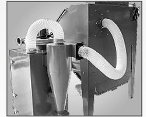
▶ Der Zyklonabscheider kann 95% Staub entfernen
