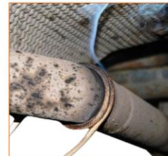
▶ Schwer zugängliche Teile können durch den Einsatz und entsprechende Anbringung von **speziellem Wickeldraht** gelöst werden
