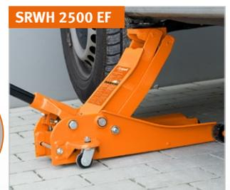
▶ **Flaches Design:** Rangierwagenheber speziell für tiefergelegte und sportlich flache Fahrzeuge mit einer minimalen Unterfahrhöhe von nur 87 mm
