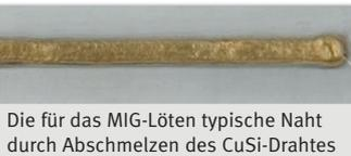
Die für das MIG-Löten typische Naht durch Abschmelzen des CuSi-Drahtes
