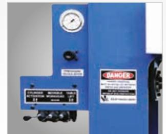
▶ Druckempfindliche Handhebel und Druckmanometer
