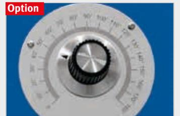
**optionale Steuerung PT 1** – manuelle Verstellung des Biegewinkels über Potentiometer bequem an der Maschinenfront
