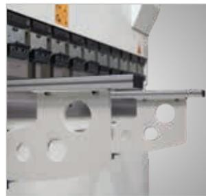
▶ Schnellverstellbare Frontauflagearme auf Linearschiene
