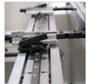
▶ Hinteranschlag X/R mit manuellen Z-Achsen
