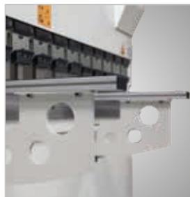
▶ Schnellverstellbare Frontauflagearme auf Linearschiene
