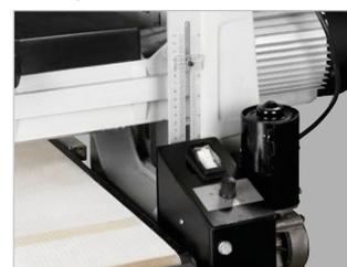
Höhenverstellung der Schleifeinheit an einer Skala ablesbar
