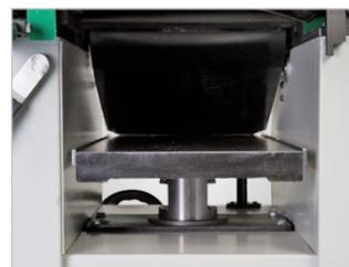
Dickentischverstellung über Handrad, Skala und numerischer Anzeige
