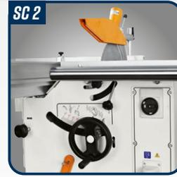
**Doppelwiegen-Sägeaggregat aus Grauguss**
