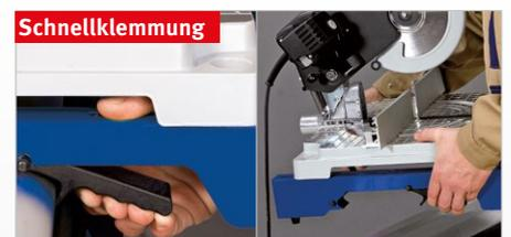
Die Halteschienen können einfach und bequem über ein Schnellklemm-System positioniert, verschoben oder abgenommen werden.
