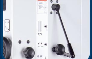
· Sägebandschnellspannung über Exzenterhebel auf Maschinenrückseite
