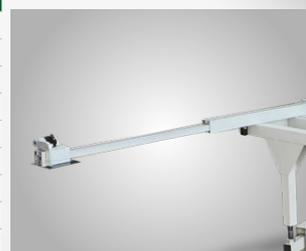
▶ Teleskopanschlag mit einer Länge von 1100 bis 1900 mm
