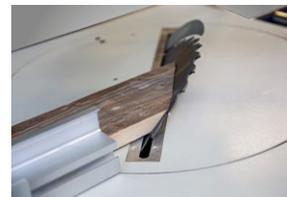
▶ Sägeblattschwenkung bis 45° und -drehung um bis zu 90°
