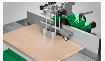
Fräsanschlag mit feineinstellbaren Aluminium-Anschlägen
