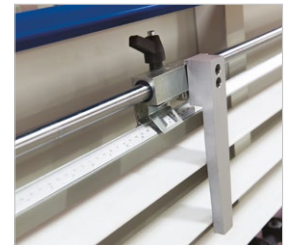
▶ Lineal zur Längeneinstellung beim Vertikalschnitt
