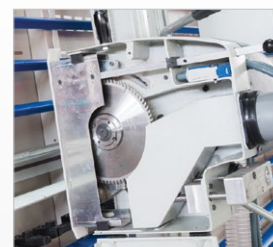
▶ Große Öffnung für Sägeblattwechsel
