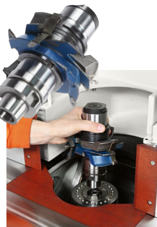
Auswechselbare Spindel, HSK
