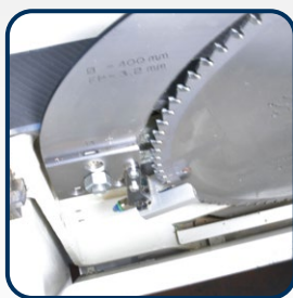
► Mikrodosierungseinrichtung direkt am Sägeblatt
