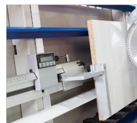
▶ Digitale Maßanzeige zur Längeneinstellung beim Vertikalschnitt
