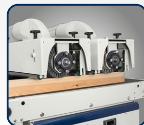
► Arbeitsaggregate können einzeln zugeschaltet werden
