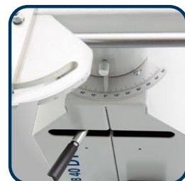
► LLB 40 DT: Arbeitstisch beidseitig um 60 Grad drehbar
