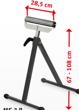
MS 3 R Mit Rollenauflage und Handgriff zur Schnellverstellung. Tragfähigkeiten: ▶ Niedrigste Position: 90 kg ▶ Mittlere Position: 60 kg ▶ Höchste Position: 45 kg
