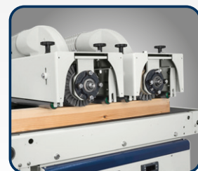
▶ Arbeitsaggregate können einzeln zugeschaltet werden
