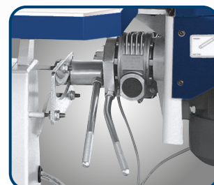
KSO 150 M Schleifaggregat über Hebel bis 45° schwenkbar
