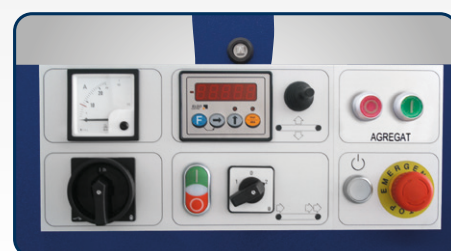
Standardmäßig mit elektronischer Abmessung der Tischposition mit Digitalanzeige
