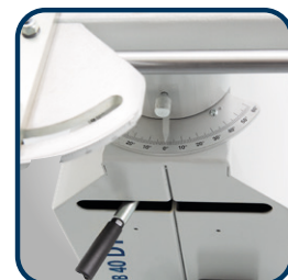
► LLB 40 DT: Arbeitstisch beidseitig um 60 Grad drehbar
