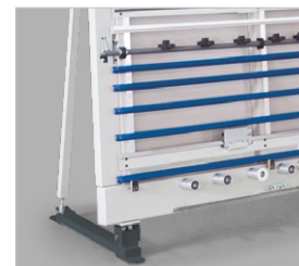
▶ Automatisch ausweichendes Lattenrost, um zu verhindern, dass das Sägeblatt in eine Rückwandlatte hineinsägt
