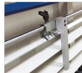
▶ Lineal zur Längeneinstellung beim Vertikalschnitt
