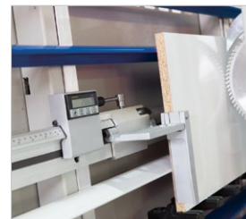
▶ Digitale Maßanzeige zur Längeneinstellung beim Vertikalschnitt
