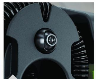
Hintere Kamera zur Kontrolle der Reinigungsleistung
