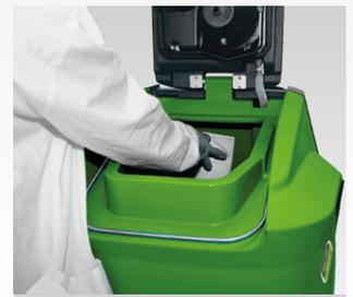
Frischwassertank mit Schlauch für Schnellbefüllung
