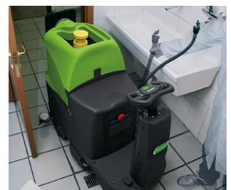
Frischwassertank mit Schlauch für Schnellbefüllung
