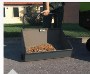
Manuelle Entleerung des Kehrgutbehälters
