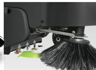
Seitenbürsten mit elektrischer Staubabsaugung
