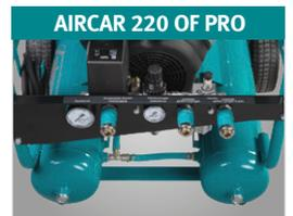
Ausgestattet mit drei Druckluftentnahmestellen und jeweils einem Manometer für Arbeitsdruck und Behälterdruck
