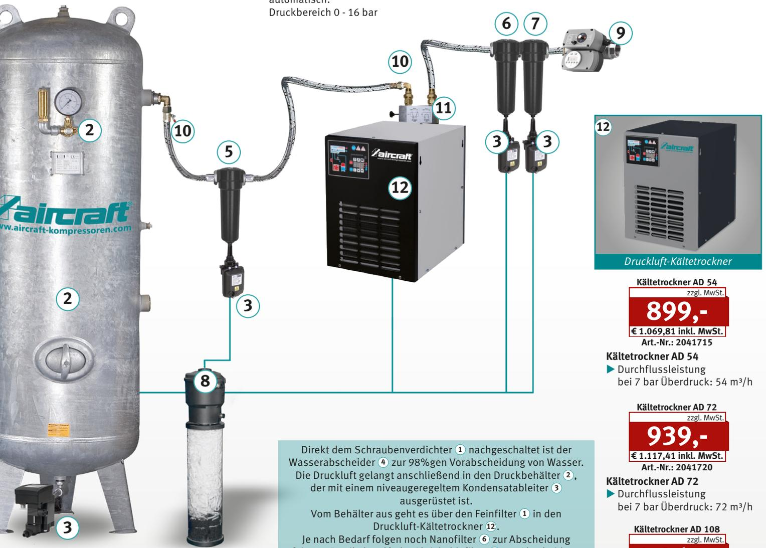
Direkt dem Schraubenverdichter 1 nachgeschaltet ist der Wasserabscheider 4 zur 98%igen Vorabscheidung von Wasser. Die Druckluft gelangt anschließend in den Druckbehälter 2, der mit einem niveaugeregeltem Kondensatableiter 3 ausgerüstet ist.
