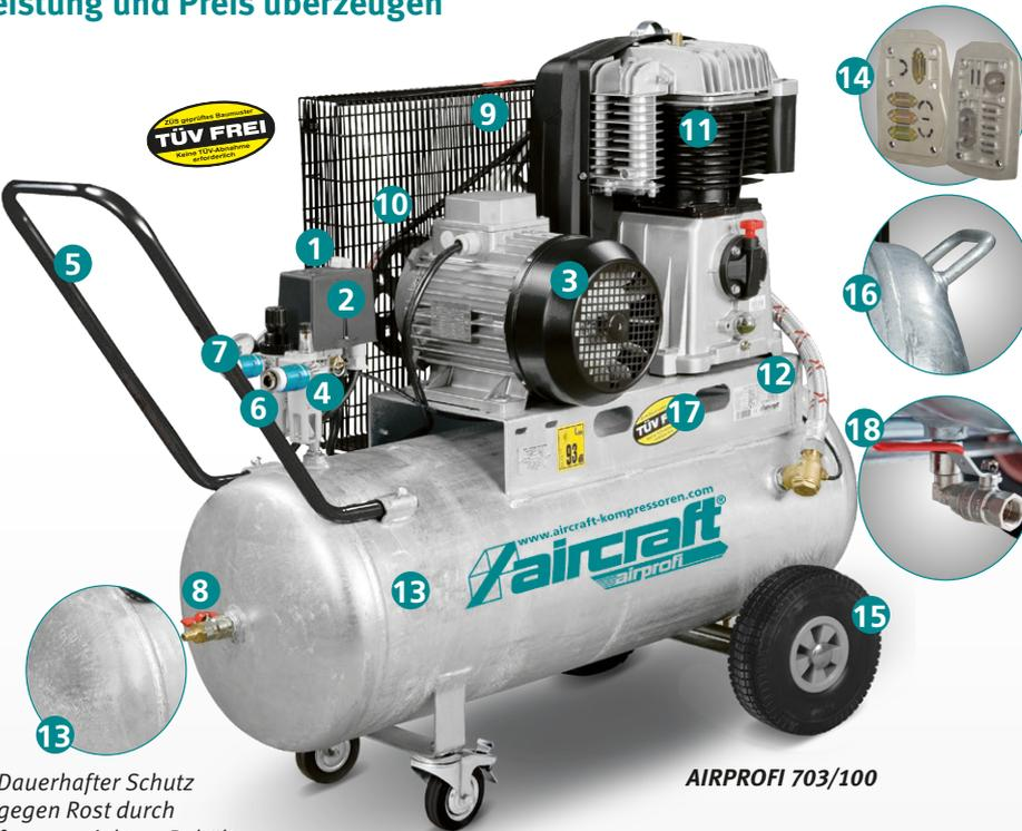
· Dauerhafter Schutz gegen Rost durch feuerverzinktem Behälter
